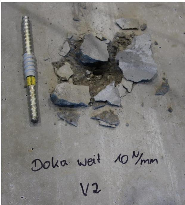
Abbildung 5-8: Versagensbild, weite Abstützung,  $11 \text{ N/mm}^2$ , Versuch 2
