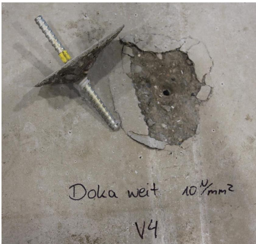
Abbildung 5-10: Versagensbild, weite Abstützung, 11 N/mm<sup>2</sup>, Versuch 4
