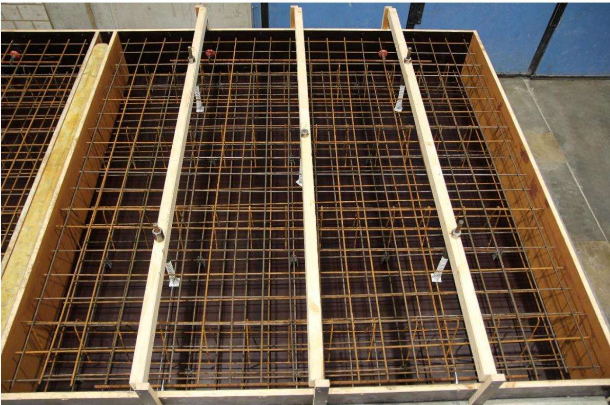
Abbildung 3-4: Doka Abschalhülse, Versuchskörper groß, 10 N/mm<sup>2</sup>
