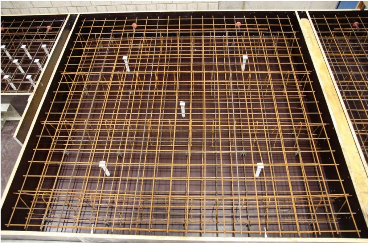
Abbildung 3-5: Doka Abschalhülse, Versuchskörper groß, 25 N/mm<sup>2</sup>
